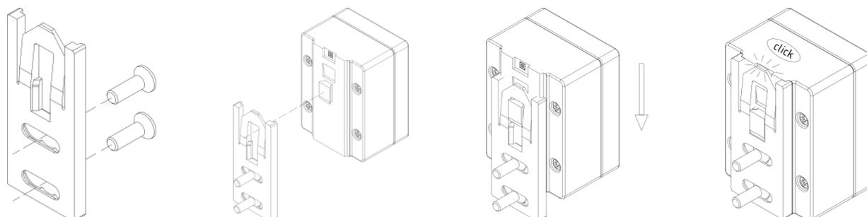
Der Halterung ist im Lieferumfang enthalten, die Befestigungsmittel (Schraube, Nutensteine) sind nicht im Lieferumfang enthalten. Bitte verwenden Sie M5 Senkschrauben nach DIN 7991/ISO 10642 mit entsprechend passender Länge. Das Anzugsdrehmoment der Schrauben für die Befestigung des Gehäusehalters beträgt  $0,7 \pm 0,1 \text{ Nm}$ .
