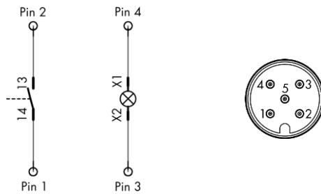
Die Drucktaste und der Wahlschalter können zusätzlich beleuchtet werden.
