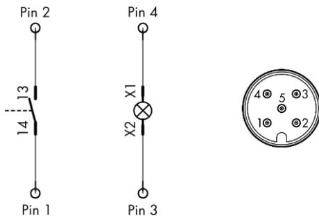
Die Drucktaste und der Wahlschalter können zusätzlich beleuchtet werden.
