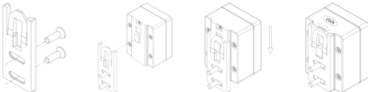
Der Halterung ist im Lieferumfang enthalten, die Befestigungsmittel (Schraube, Nutensteine) sind nicht im Lieferumfang enthalten. Bitte verwenden Sie M5 Senkschrauben nach DIN 7991/ISO 10642 mit entsprechend passender Länge. Das Anzugsdrehmoment der Schrauben für die Befestigung des Gehäusehalters beträgt  $0,7 \pm 0,1$  Nm.
